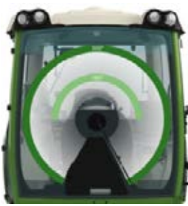
De 300°-ruitenwisser vergroot uw gezichtsveld en houdt de voorruit schoon, zelfs onder de moeilijkste omstandigheden. Zo hebt u altijd vrij zicht – over de volledige voorzijde van de trekker en op de wielsporen.
