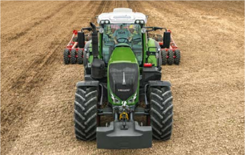
De Fendt 800 Vario is qua overzichtelijkheid optimaal ingericht. De kap is zo slank mogelijk gehouden, zodat de bestuurder uitstekend zicht heeft op wielspoor en frontwerktuig.
