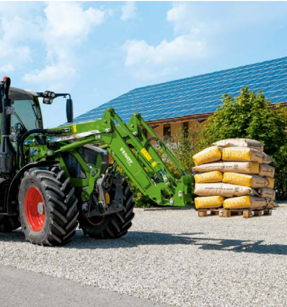
Alle hydrauliekcomponenten zijn in de dwarsbalk ondergebracht. Daarmee zijn ze optimaal beschermd tegen verontreiniging en mechanische beschadiging.
