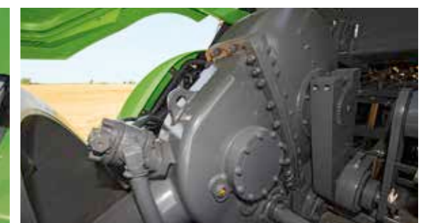
In de XD-pers is een nieuwe aandrijving ingezet met meer vermogen. De XD-aandrijving is in totaal zo'n 35% zwaarder als in het standaardmodel en kan zo nog meer persdruk genereren.
