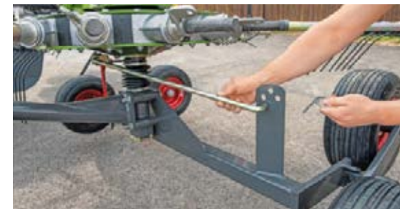
Of het materiaal nu zwaar, kort of licht is: de curvebaan past u eenvoudig aan de oogstomstandigheden aan.
