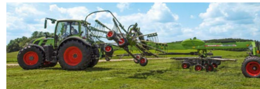
De volgordebesturing heft de rotoren van de Fendt Former zwadhark op de kopakker perfect uit.
