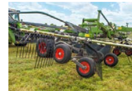
Bij het laten zakken op de kopakker raken eerst de achterste wielen de grond, daarna de voorste. Bij het uitheffen gaan de voorste rotoren het eerst omhoog. Dankzij dit zgn. jet-effect wordt de zode ontzien.
