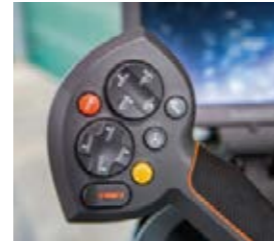
■ Multifunctionele joystick OptiControl, geoptimaliseerd voor gewasbescherming
