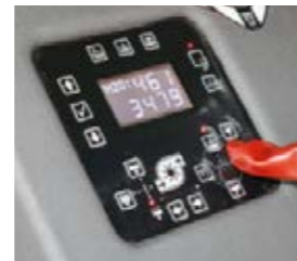
■ Met behulp van OptiFlow-bedieningscentrum en vultrechter worden tijdens het vullen alle meng- en vulfuncties comfortabel bediend.
