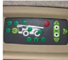
■ Schakelknoppen voor zowel afzonderlijke werkklampen als alle werkklampen samen, en voor het ruitenwissersysteem
