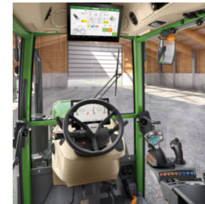
Profi Setting 2 - 3L-joystick - 2 lineaire modules (1 paar wipschakelaars) voor het bedienen van de hydrauliekventielen - 12"-terminal
