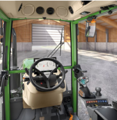
Profi Setting 1 - Kruishendel - 2 lineaire modules (1 paar wipschakelaars) voor het bedienen van de hydrauliekventielen
