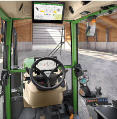
Profi+ Setting 1 - Kruishendel - 2 lineaire modules (1 paar wipschakelaars) voor het bedienen van de hydrauliekventielen - 12"-terminal
