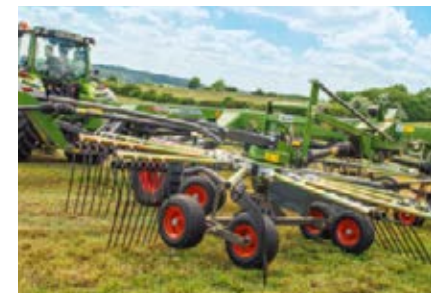
Bij het laten zakken op de kopakker raken eerst de achterste wielen de grond, daarna de voorste. Bij het uitheffen gaan de voorste rotoren het eerst omhoog. Dankzij dit zgn. jet-effect wordt de zode ontzien.
