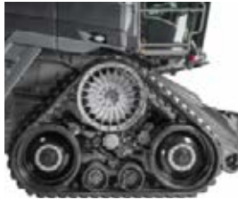
Het TrakRide-rupsonderstel heeft een in verhouding zeer geringe bodemdruk.
