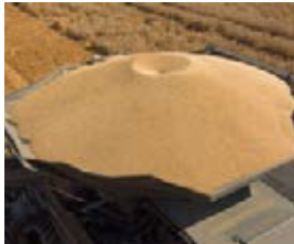
De Streamer 210 heeft maar ca. 81 seconden nodig om de hele inhoud van 17.100 liter over te laden.
