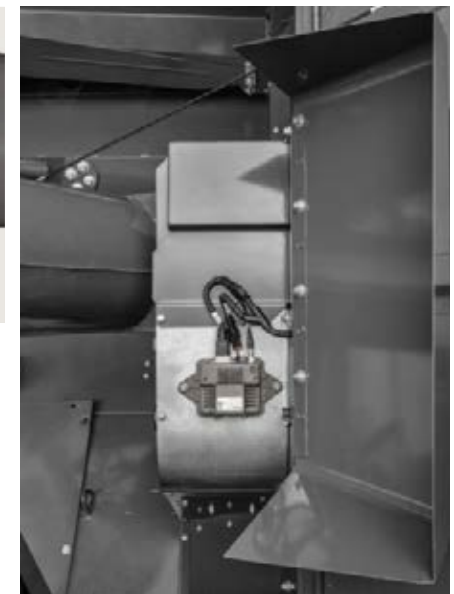
Opbrengst, vochtgehalte en kwaliteit altijd in beeld dankzij de live-data vanaf het perceel: aan de elevator zijn opbrengst- en vochtigheidssensoren en de camera voor bewaking van de korrelkwaliteit aangebracht. De gegevens hebben een nauwkeurigheid van 98% en worden dankzij de ISOBUS-standaard benut door VarioDoc, live-opbrengstkaartering en IDEALharvest™.
