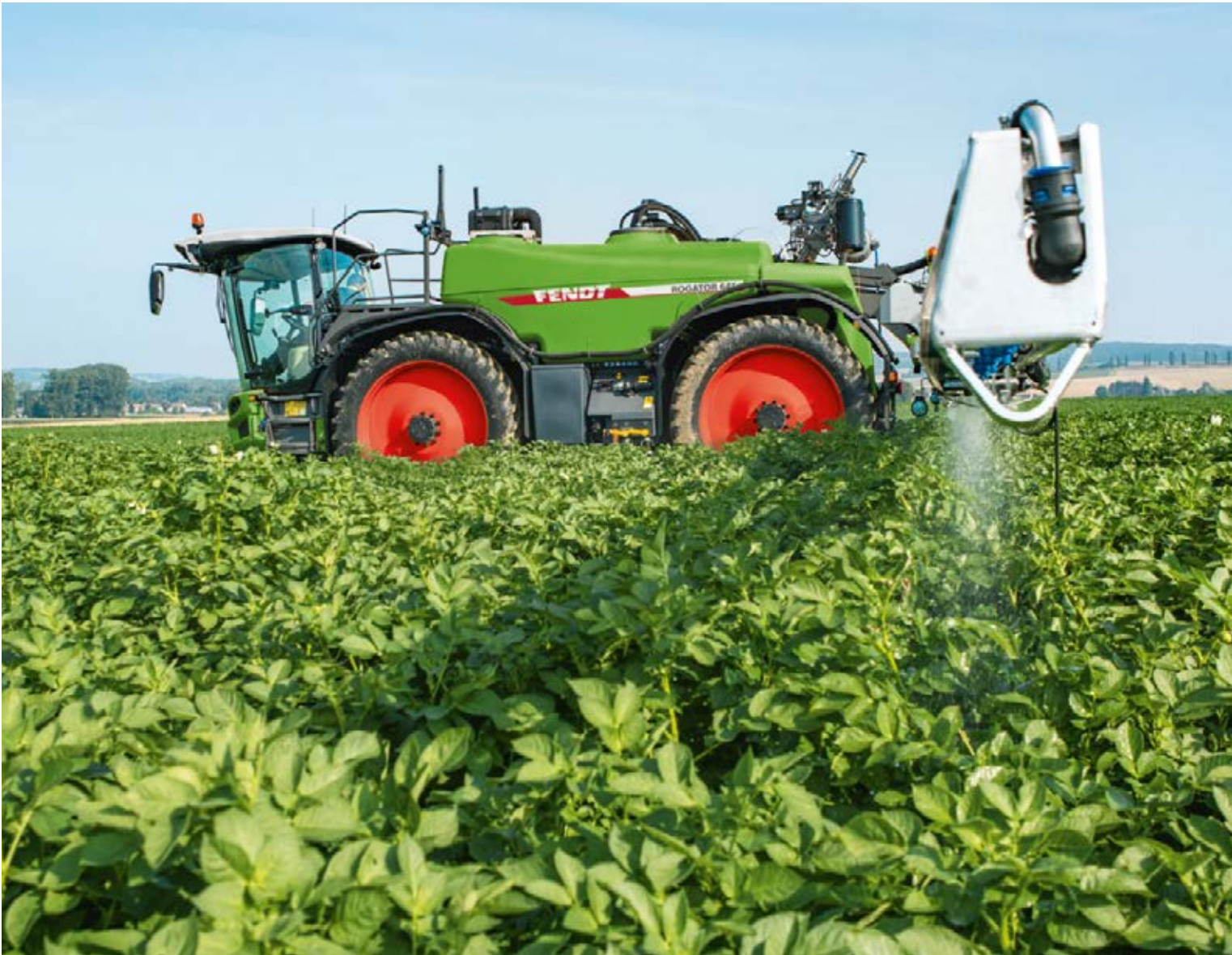
De pompcapaciteit van maximaal 785 l/min maakt ook het opbrengen van vloeibare kunstmest een fluitje van een cent. De hydraulische aandrijving van de centrifugaalpomp vraagt via het CDS slechts zo veel hydraulische capaciteit als werkelijk nodig is. De Fendt Rogator rijdt steeds in het bereik met optimaal rendement, met een zo laag mogelijk motortoerental.
