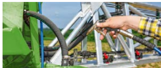
□ Het perslucht pistool (optie) bevindt zich achter aan de spuitboom, zodat u snel kunt reinigen.
