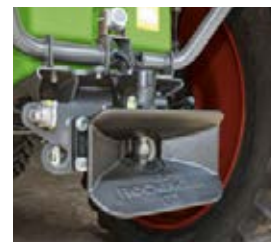
□ Automatische trekhaak met aansluitingen voor remmen en elektronica
