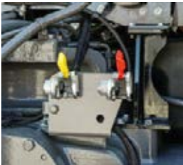
■ Voor luchtgeremde werktuigen is een volwaardige drukluchtinstallatie aanwezig.
