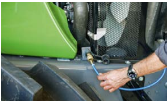
Voor aan de trekker bevindt zich een persluchtaansluiting voor de reiniging van de koeler.
