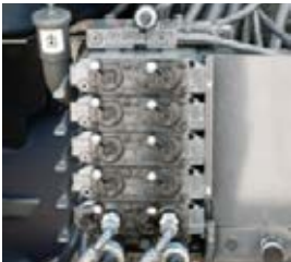
□ Achter aan de trekker bevinden zich zes hydrauliekventielen, een lekolieaansluiting en PowerBeyond.
