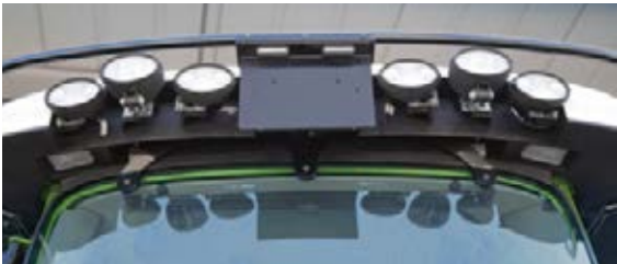
■ Halogeen-werklampen zorgen voor een perfecte verlichting van de omgeving. Indien gewenst zijn led-lampen leverbaar.
