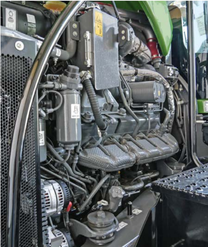
■ De 12-cilinder AGCO Power-motor imponeert door zijn rustige loop en goede toegankelijkheid voor onderhoud.
