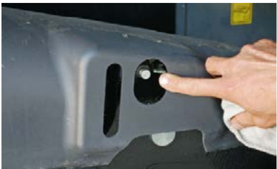
De luchtdrukaansluitingen om de rupsbanden te spannen zijn goed toegankelijk.
