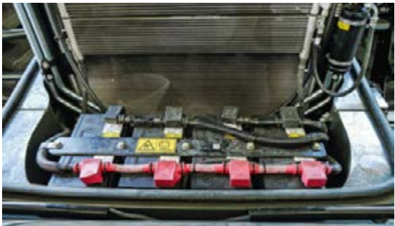
In de Fendt 1100 MT wordt de stroom verzorgd door vier onderhoudsvrije accu's.
