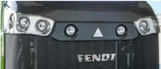
■ Ook naar voren en opzij wordt het werterrein uitstekend verlicht. Als optie zijn ook ledlampen leverbaar.
