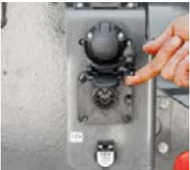
■ Voor externe verbruikers is een 12V-aansluiting aan de achterzijde van de trekker aanwezig. De ISOBUS-aansluiting vormt de verbinding met de werktuigen.
