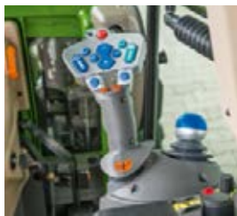
De grote multifunctionele joystick (optie) biedt u de perfecte bediening, zonder omgrijpen.
