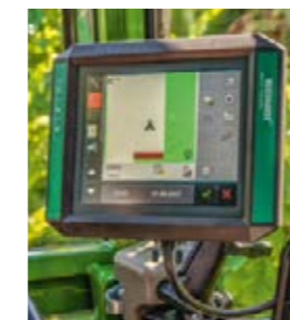
De spoorgeleidingsterminal is optimaal geïntegreerd en goed afleesbaar.
