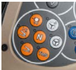
Het VarioActive-snelstuursysteem en het spoorgeleidingssysteem worden eenvoudig geactiveerd op de console aan de stuurkolom.
