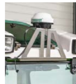
Gps-stuursystemen op basis van positie-referenties werken bij de Fendt 200 V/F/P Vario met een nauwkeurigheid van maximaal 2 cm.
