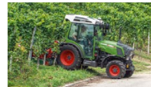
De aftakassen werken onafhankelijk van de rijnsnelheid. Met een klepelmaaier bijvoorbeeld rijdt u bij een dicht gewas langzaam en bij een meer open gewas sneller – traploos, zonder schakelen en zonder onderbreking van de krachtstroom.
