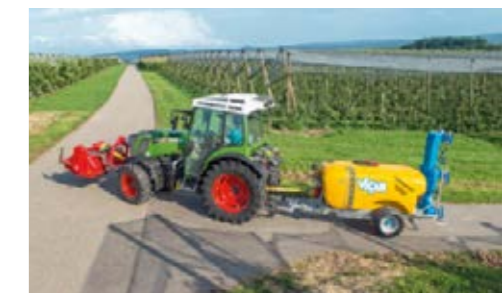
Efficiënt combineren van werkgangen: met de 540E/750 frontaftakas houdt u voor de klepelmaaier het bedrijfstoerental aan, terwijl de achter de trekker gekoppelde spuit en de trekker zelf nog steeds gebruikmaken van het verlaagde motortoerental.
