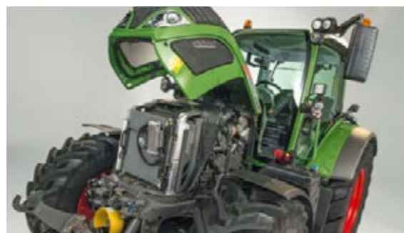
De motor is zeer goed toegankelijk voor controle en onderhoud, ook als delen van de voorlader gemonteerd zijn. De motorkap met twee afzonderlijke zij-elementen is eenvoudig te openen.
