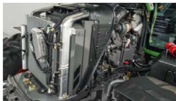
Minder inspanning, meer vrije tijd: het compacte koelpakket is zeer goed toegankelijk en door de grote tussenruimte tussen de koelplaten en de vlakke bodem van de koeler gemakkelijk en snel te reinigen.
