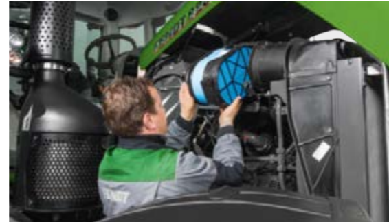
Het luchtfilter kan snel en eenvoudig worden uitgenomen.
