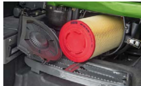
Het cabinefilter bevindt zich op een goed bereikbare plaats ter hoogte van de instap en kan indien nodig worden gereinigd.
