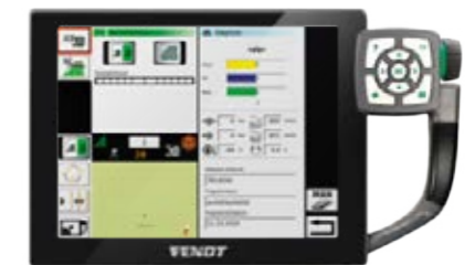
De Varioterminal geeft informatie over de geplande onderhouds- en servicebeurten. Er is zelfs een memofunctie.
