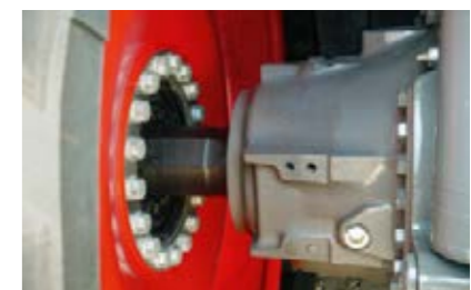
De robuuste achteras is gebouwd met een zeer lange levensduur als uitgangspunt. De eigen oliehuishouding kan eenvoudig worden gecontroleerd via kijkglazen.
