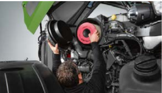
De mate waarin de luchtfilters verontreinigd zijn, wordt op de Varioterminal aangegeven. De motorruimte is door de afneembare zijstukken zeer goed toegankelijk.
