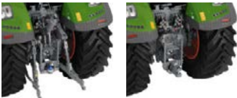
Achterste hefinrichting met vanghaken en zijwaartse stabilisatie Zonder achterste hefinrichting
